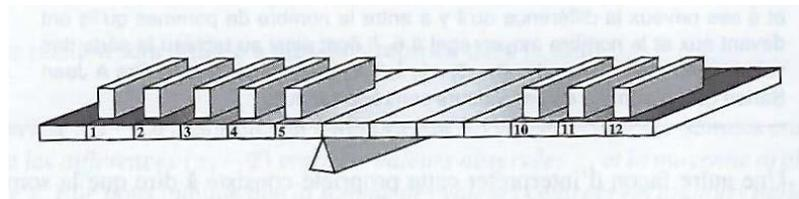
FIGURE 3 – Recherche du centre de gravité<sup>7</sup>
